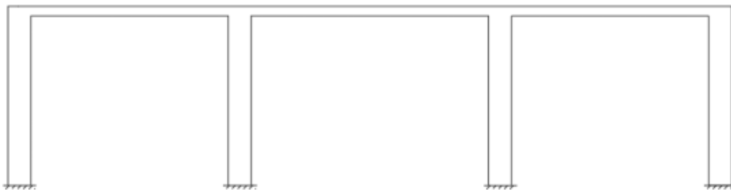
شکل ۶۴: رفتار قاب پایه های میانی و عرشه در جهت طولی پل
